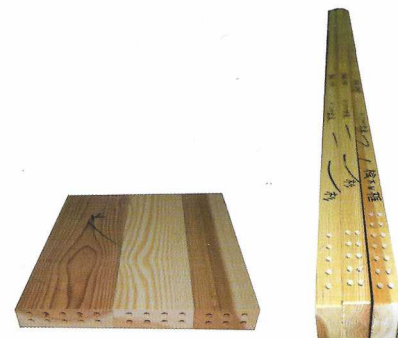
▲木口、木端面のボール盤加工
