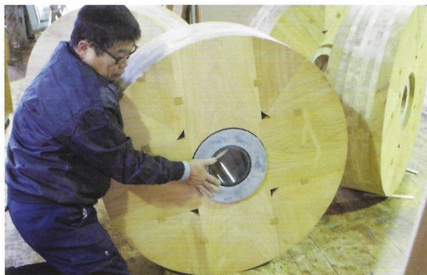
木ねじで留めて車軸留めをはめて完成間近
