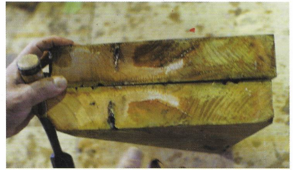
片面塗リ 接着ムラがひどく割れやすい
