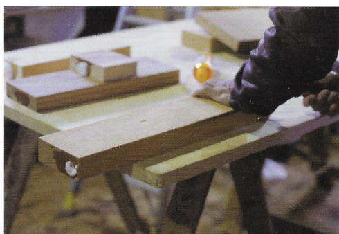
(写真9) 長い ひのき 松材は白太だけ空気が通った
