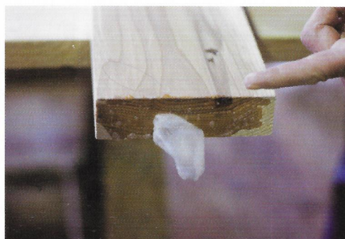
(写真6) 反対側の小口の白太から泡が出てきた
