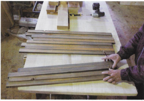
(写真1) 杉の透過性を実験した際の試験体
