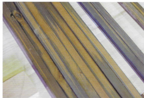
(写真2) 青いのは薬液が浸透した白太 茶色いのは薬液が浸透しない赤身
