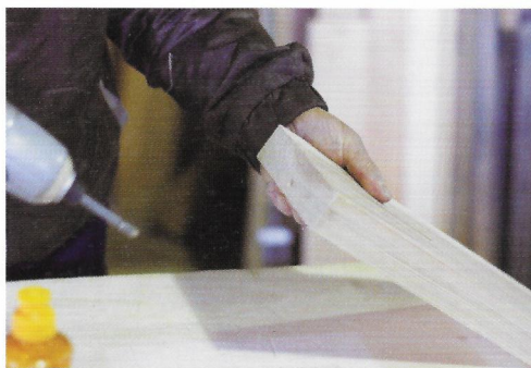
(写真4) 反対側の小口の白太 しらた にくぼみをつける
