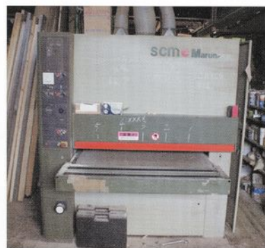
イタリア製のワイドサンダーとベルトの内側にはったガムテープ
