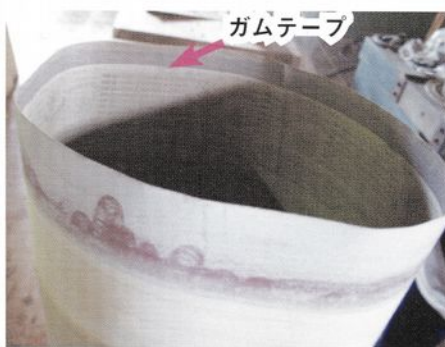
イタリア製のワイドサンダーとベルトの内側にはったガムテープ
