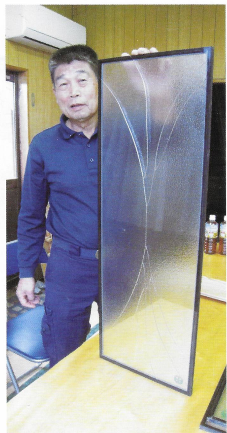
熱割れを起こしたガラス（右が1階階段中段、中央と左が2階）
