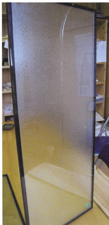
熱割れを起こしたガラス（右が1階階段中段、中央と左が2階）
