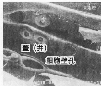
杉の赤身は細胞に蓋（弁）が付いて閉じられており水を通さないため、屋外でも木が長持ちする
