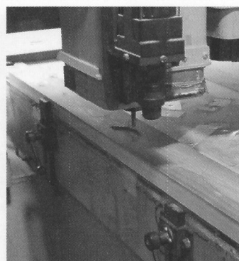
守谷建具のNCルーターを使ったドア加工
